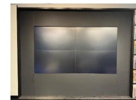
壁面モニタ 55インチ*4面 (HDMI端子)
